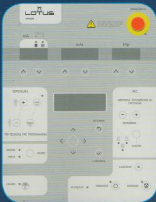
PAINEL DE COMANDO
